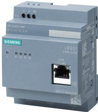
LOGO! CSM12/24 Compact Switch Module para conectar un LOGO! (. .0BA7/...0BA8) y hasta 3 dispositivos más a Ind. Ethernet a 10/100 Mbits/s unmanaged Switch, 4 puertos RJ45, 1 puerto frontal para diagnóstico, alimentación 12/24 V DC diagnóstico LED, diseño LOGO!
