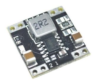
Cargador para baterías de litio de tres celdas, con control de corriente. Compatible con fuentes de alimentación o panel solar. Es de ultra alta eficiencia y genera muy poco calor.
