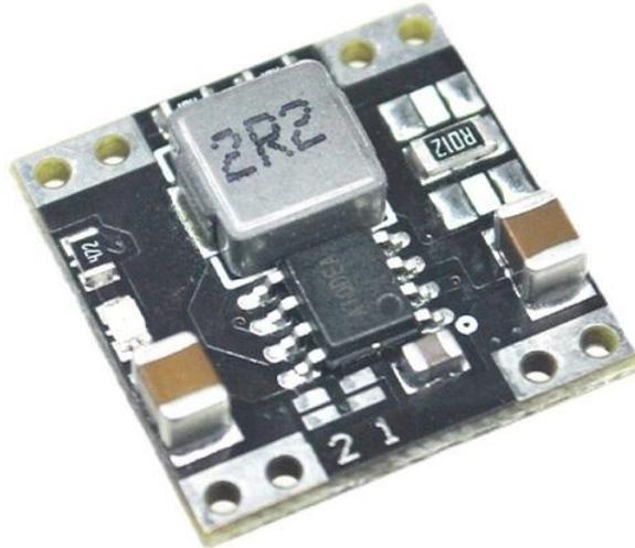
Cargador para baterías de litio de una celda, con control de corriente. Compatible con fuentes de alimentación o panel solar. Es de ultra alta eficiencia y genera muy poco calor.
