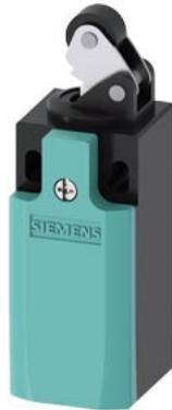
interruptor de posición caja de plástico según DIN EN 50047, 31 mm Conexión del aparato 1x (M20 x 1,5) 1NA/1NC contactos de acción brusca integrado (no intercambiables) palanca de rodillo con rodillo de plástico de 13 mm
